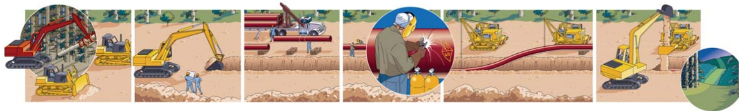
Déblayage/Nivellement Creusement/Sautage Bardage/Cintrage Franchissements Soudure/En terre Remblayage/Nettoyage
